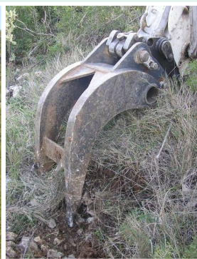
Ahoyado con retroaraña en las zonas de pendiente, con cazo de 2 puntas debido a la elevada pedregosidad
