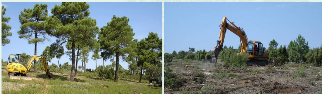
Ahoyados con miniretro de 9 tn y retroexcavadora de 30 tn, en zonas las zonas llanas y muy pedregosas
