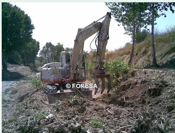
Apero diseñado por FORESA para la eliminación del rizoma. Alcanza una eficiencia superior al 98%.
