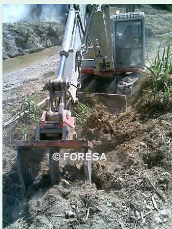
Apero diseñado por FORESA para la eliminación del rizoma. Alcanza una eficiencia superior al 98%.
